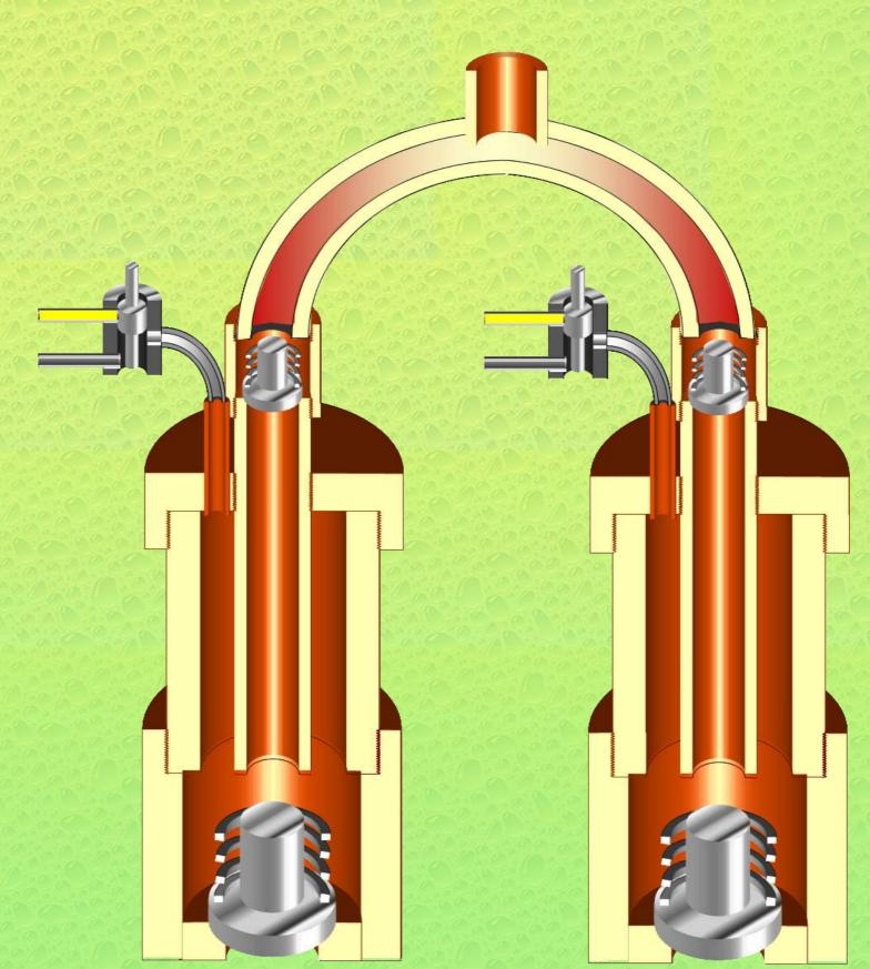
Se observa que para extracciones con mayores requerimientos de caudal y con flujo constante del mismo se emplea el sistema de dos cilindros colocados en forma paralela de trabajar puedan manera alternadamente. Este sistema puede funcionar en combinación con el sistema serie reduciendo así la presión de trabajo de todo el sistema y obteniendo mayor caudal al mismo tiempo. Los tiempos de inyección de aire comprimido para cada cilindro son regulados por controlador e electrónico
